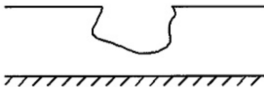
حفر گودال برای انجام آزمایش دانسیته در محل
